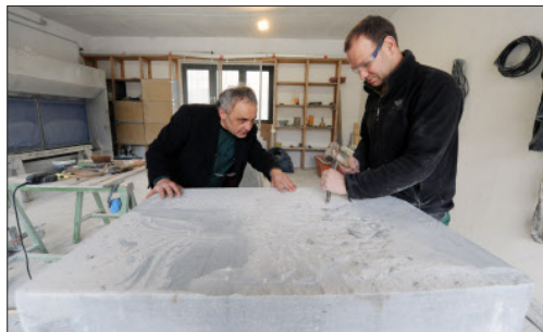
Rund zwei Wochen wird er noch dauern bis alle Unebenheiten beseitigt sind. Diese Arbeit übernimmt der Steinmetzmeister Karl-Jürgen Koch.
